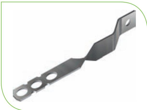
Son elementos metálicos de acero inoxidable cuya función es la retención o sujeción de la fábrica a los soportes estructurales capaces de transmitir toda o parte de la reacción horizontal debida a la acción del viento.
