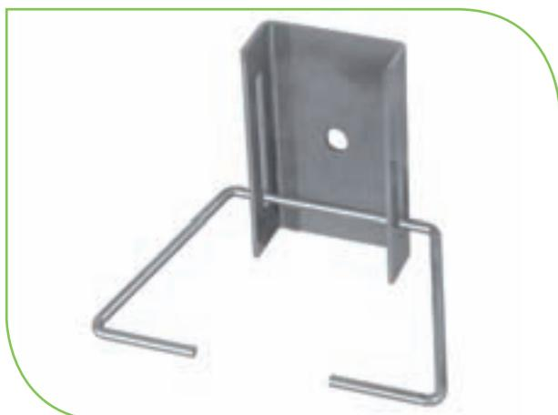
Son elementos metálicos de acero inoxidable cuya función es la sujeción o retención de la fábrica a elementos estructurales que permiten libertad de movimiento en las dos direcciones contenidas en el plano del muro.
