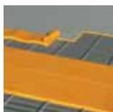
**Cubiertas de doble chapa metálica con separadores:** sistemas de cerramientos formados por dos chapas metálicas trapeciales, con inclusión de aislamiento intermedio. Este cerramiento es frecuentemente utilizado en la construcción de naves industriales. Se utiliza también para la rehabilitación térmica y acústica en edificaciones industriales.
