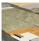
**Suelos flotantes.** Para obtener un aislamiento que proporcione simultáneamente prestaciones térmicas y acústicas la única solución viable consiste en disponer de un suelo flotante sobre un aislante elástico colocado bajo el pavimento como intercalario elástico entre el forjado y el pavimento, que actúa como un muelle para amortiguar el ruido de impacto en los forjados.
