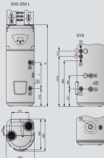
Diámetros conexión conducción aire disponibles de serie (in y out): Ø150 mm, Ø160 mm, Ø200 mm.
