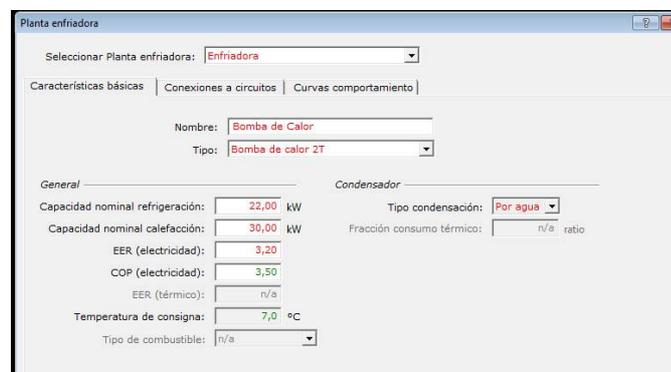
Fig 4. Programa HULC-GT. Bombas de calor Aire-Agua y Agua-Agua
