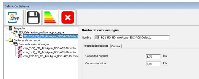
Fig 3. Programa HULC-VYP. Bombas de calor Aire-Agua
