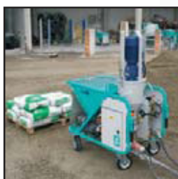
Con un potente motor eléctrico trifásico, que garantiza un alto rendimiento en la mezcla y proyección de morteros premezclados, yesos y monocapas de los diferentes fabricantes existentes en el mercado
