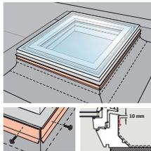
El perfil de aluminio ZZZ 210 permite la compatibilidad de soldadura de algunas láminas bituminosas con el PVC del marco de la ventana.
