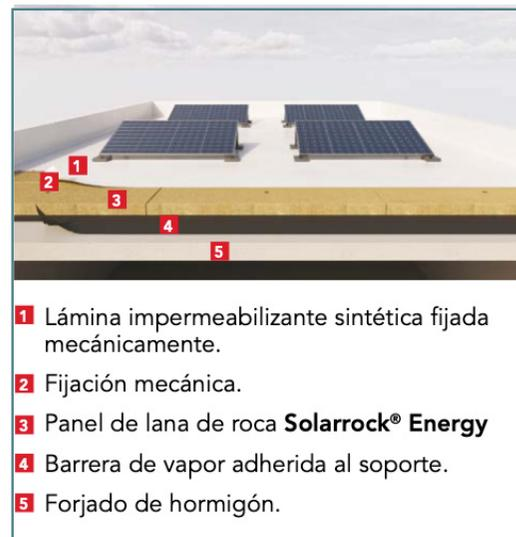
En una cubierta plana tradicional la lámina impermeabilizante es la última capa exterior que protege a todos los elementos de la solución garantizando su durabilidad.
